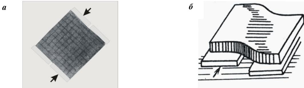
**Рис. 6.** Схема нагружения плиты в виде плоского простого сдвига – однородный по глубине простой сдвиг: а – с торцевыми штампами [Осокина, 1960, 1963]; б – продольными боковыми пластинами (подложка с широкой щелью) [Бондаренко, 1991]
